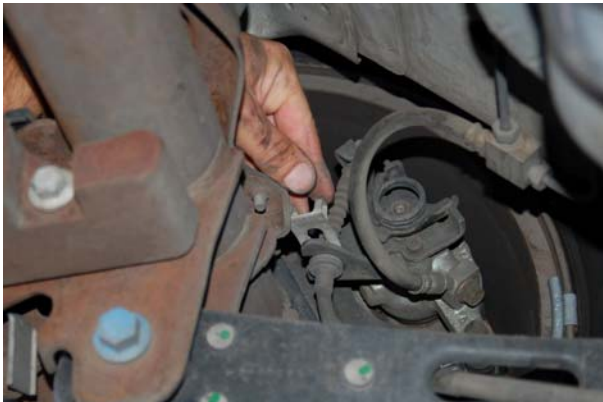
Remove brake cable clip
